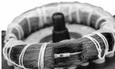
Obr. 48 Snímač PTC zabudovaný ve vinutí
