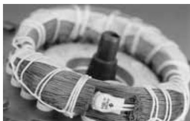
Obr. 50 Teplotní spínač zabudovaný ve vinutí
